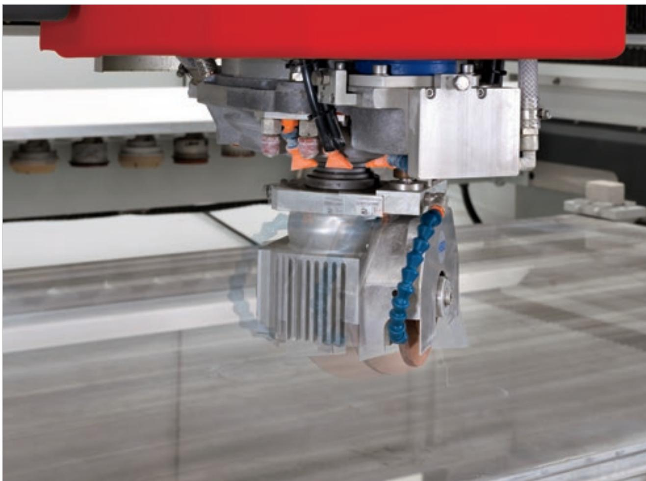
ASSE C ROTATIVO INFINITO PER L'ESECUZIONE PERFETTA DELLE LAVORAZIONI PIÙ COMPLESSE IN MODO FLUIDO E PRECISO .
