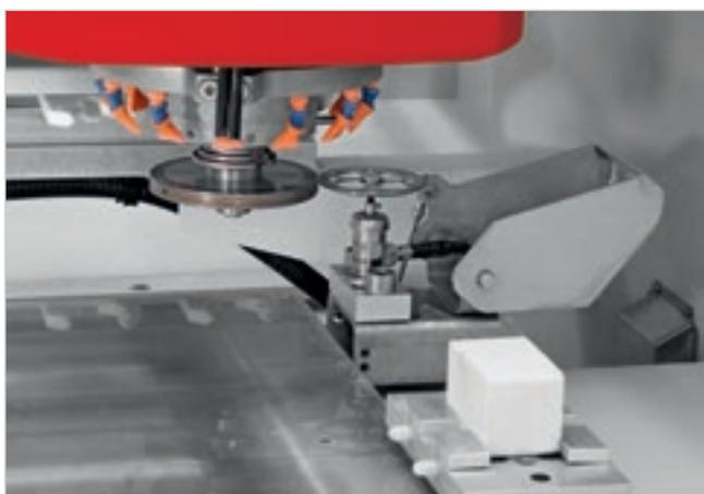
Master One può essere equipaggiata con il **presetter meccanico** che grazie al sistema completamente automatico, con massima semplicità e rapidità, permette di avere una misura sempre precisa ed aggiornata degli utensili durante i processi di lavorazione ed evitare errori da parte dell'operatore.
